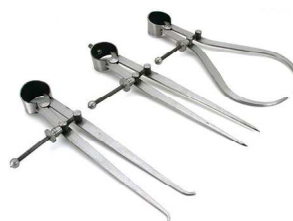
Utilização do compasso bailarino como compasso de exteriores e interiores
